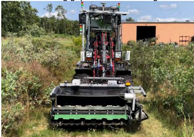
Autonomer, elektrischer Traktor SunBot in der Blaubeerplantage
